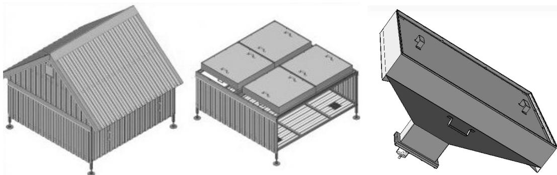
Рис. 1. Детектирующая станция установки НЕВОД-ШАЛ (слева и в центре) и геометрическая модель детектора в программной среде КОМПАС (справа).
