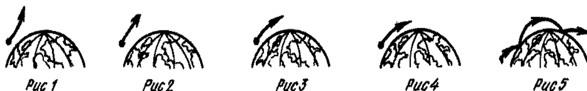
Рис. 2. Виды рефракции в тропосфере. 1 – отрицательная, 2 – отсутствие рефракции, 3 – нормальная, 4 – критическая, 5 – сверхрефракция
